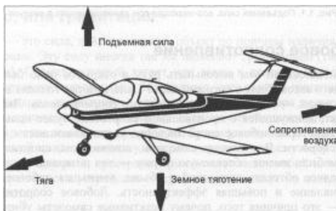
Рис. 1.2. Силы, возникающие в полете, на примере самолета
